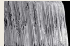
Грубый, неравномерный износ
